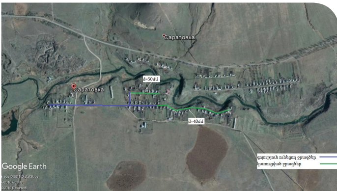
Սարատովկա համայնքի ջրամատակարարման սխեմա
