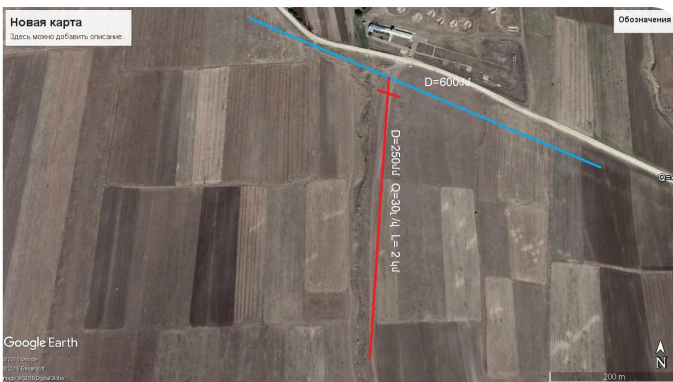
Զույգադրյուրի ջրատարի՝ Հովուների համայնքի ջրամատակարարման սխեմա
