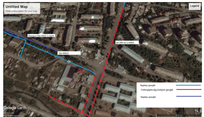
Լենինգրադյան փողոցի տնակային ավանի ջրամատակարարման սխեմա
