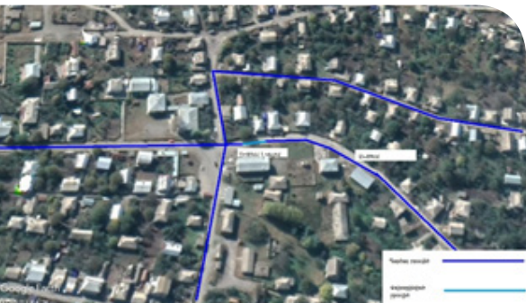
Գուգարք համայնքի ջրամատակարարման սխեմա
