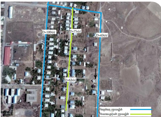
Թալին քաղաքի Թամանցիներ փողոցի ջրամատակարարման սխեման
