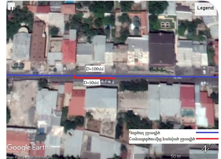
Սևաստոպոլյան փողոցի ջրամատակարարման սխեման
