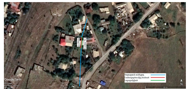
Թբիլիսյան Միմաֆոր թաղամասի ջրամատակարարման սխեմա
