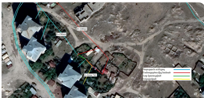
Բուլվարային թաղամասի ջրամատակարարման սխեմա
