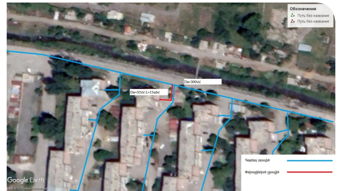
Զուխաջյան թաղամասի ջրամատակարարման սխեմա
