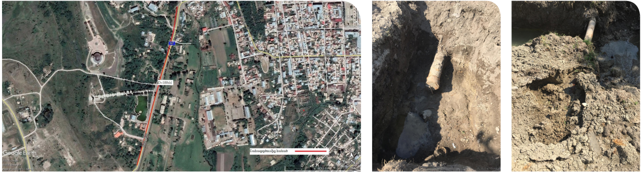
Արդյունքում շահագործումից հանվել է D=300մմ, L=975մ խողովակաշար:
